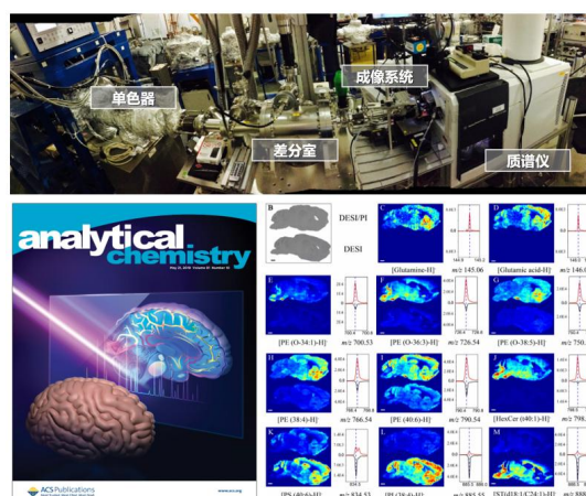
图 14. 二次光电质谱成像技术 (DESI-PI-MSI) 装置图 (上)、封面文章 (左下) 和小鼠脑切片图 (右下)
