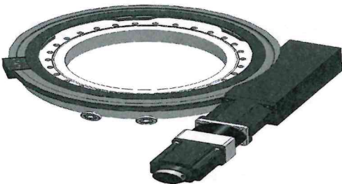
图 1 样品高精度旋转装置模型示意图
