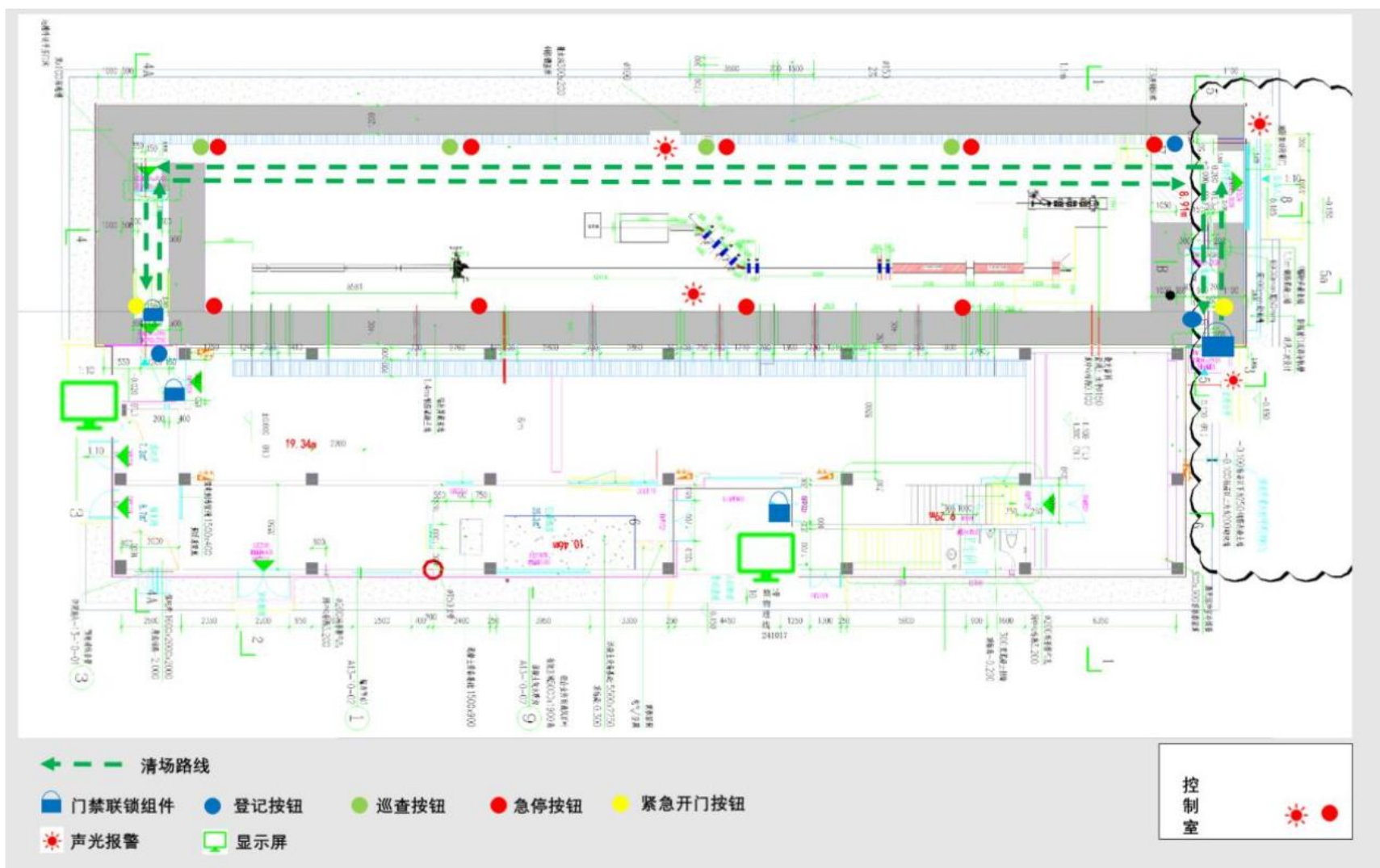
图 4.3-2 门禁联锁组件及按钮组件布局示意图
