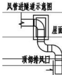
图 4.3-11 通风管道穿墙示意图
