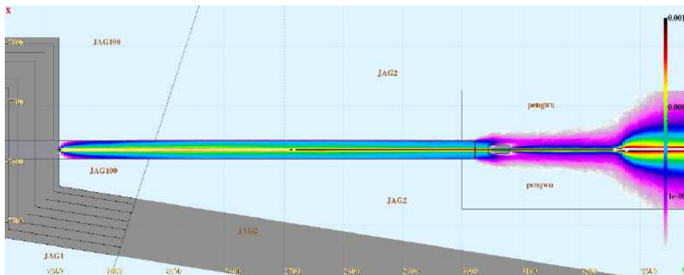
图 5-38 2%注入电子损失在直线节管壁上，管道外 15cm 处添加 10mm 的铁，彩色区域表示剂量率大于 2.5\mu\text{Sv/h}
