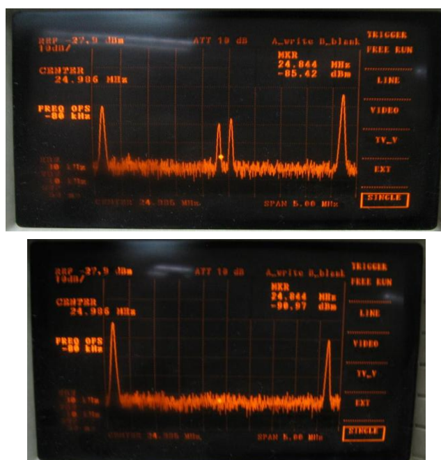
a 注入不加反馈系统时频谱曲线
