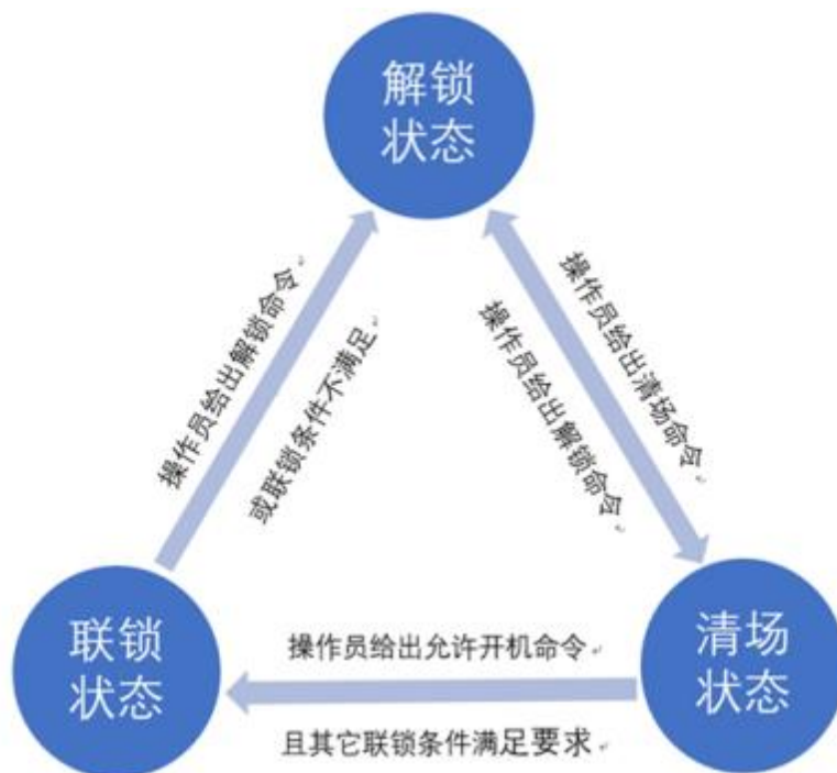
图 4.3-5 安全联锁系统状态迁移图
