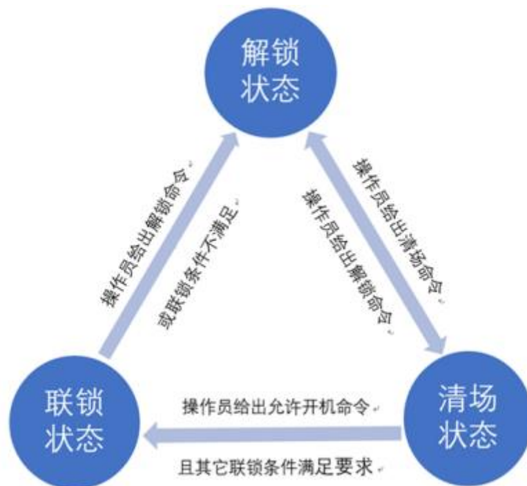
图 4.3-5 安全联锁系统状态迁移图
