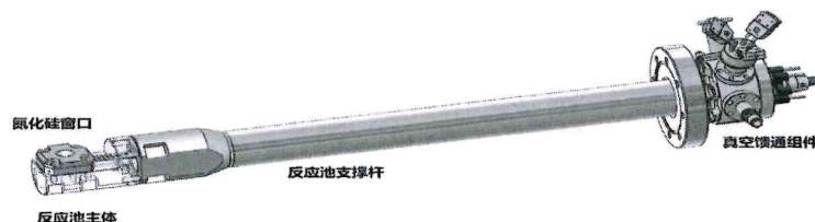
图 2：动态气相反应池示意图
