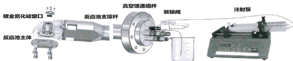
图 1：动态液相反应池示意图
