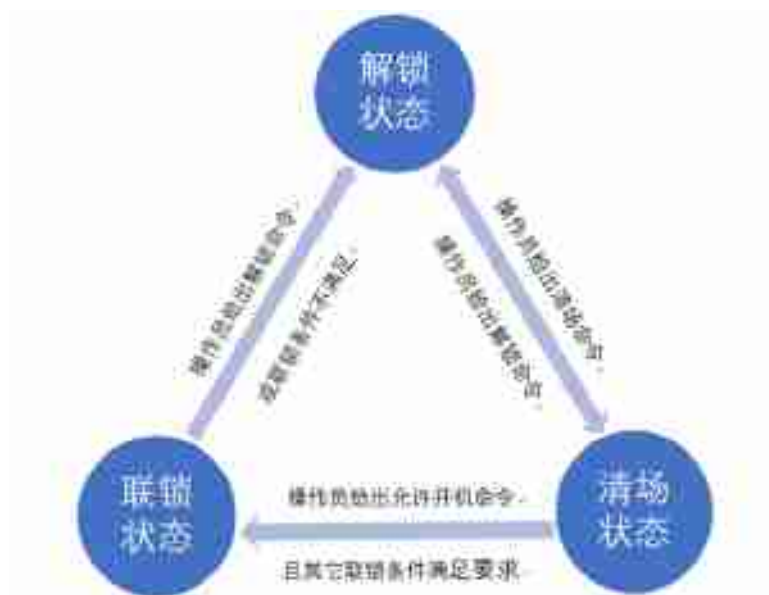
图 4-12 安全联锁系统状态迁移图
