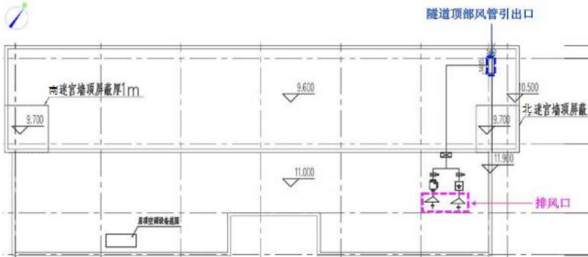
图 4.3-10 加速器测试大厅排风口位置示意图
