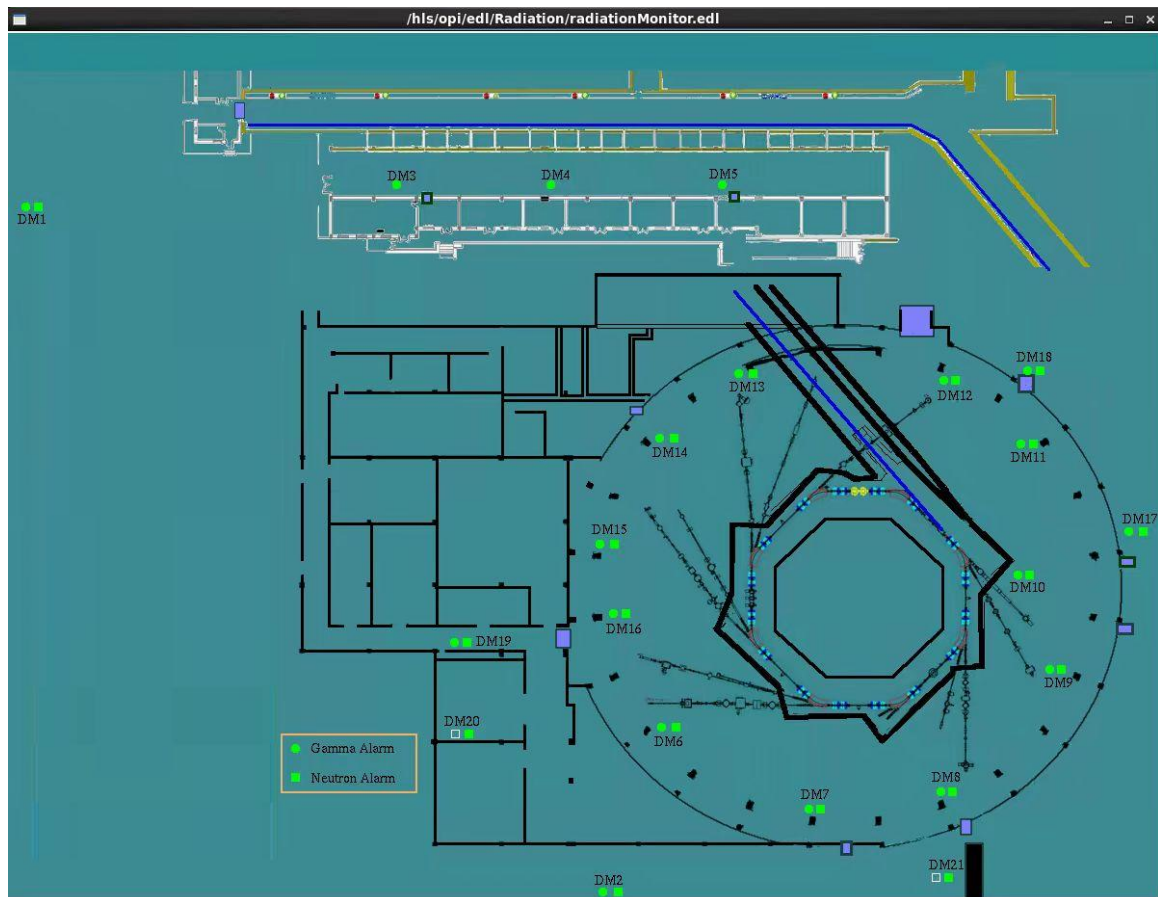
图 A.5.2-7 合肥光源辐射监测系统
