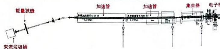
图 1-4 电子直线加速器总体布局示意图
