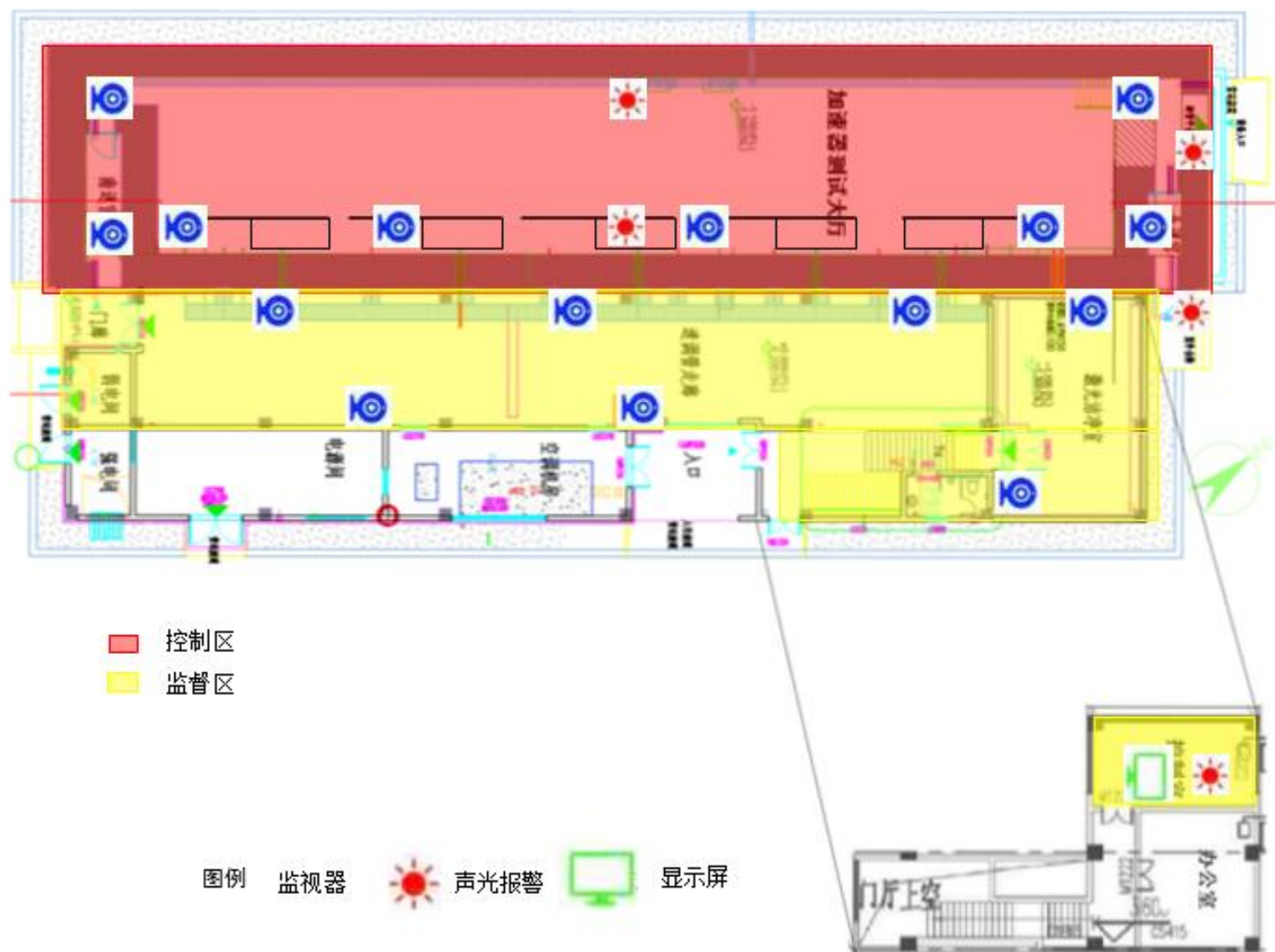
图 A.5.1-5 安全联锁系统警示装置布局
