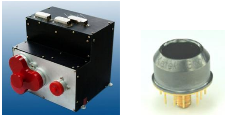
图1 太阳X射线探测器实物图（左）、SDD传感器实物图（右）
