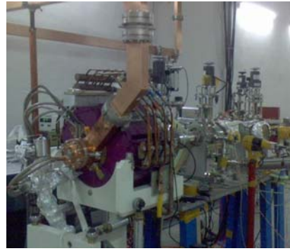
图 2 光阴极电子枪组装图
